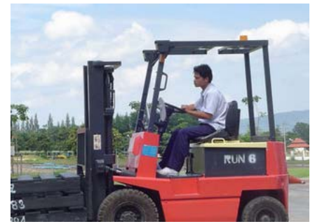
บนช่วงยกที่ความสูง 4,775 มม. ในขณะที่ยาง เดิมลม สามารถรับน้ำหนักได้เพียง 210 กก. ที่ ความสูง 4,300 มม.
